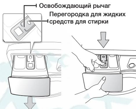
3. Промойте все части отсека проточной водой.
