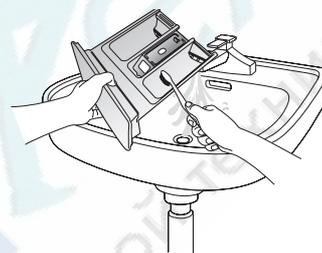
4. Очистите нишу для отсека с помощью старой зубной щетки.
