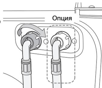
6. Включите подачу воды и убедитесь, что нет протечки воды из клапана подачи воды, крана или адаптера. Если есть протечка воды, повторите предыдущие действия.
