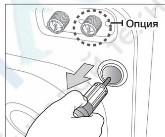
3. Закройте отверстия с помощью прилагаемых пластмассовых заглушек.
