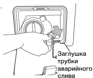
4. Возьмитесь за крышку на конце трубки аварийного слива и медленно вытяните ее примерно на 15 см.
