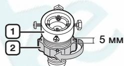
3. Подсоедините адаптер к водопроводному крану и туго затяните винты, поднимая адаптер вверх. Поверните часть (2) в направлении, указанном стрелкой, и соедините части (1) и (2).
