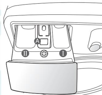
4. При использовании цикла предварительной стирки рекомендуемое количество средства для стирки следует добавить в отсек ① для предварительной стирки.
