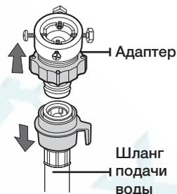
2. С помощью крестообразной отвертки ослабьте четыре винта на адаптере. Затем поверните часть (2) адаптера в направлении, указанном стрелкой, пока не образуется зазор шириной около 5 мм.
